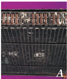
A. Un courant vagabond peut provoquer une corrosion excessive des composants métalliques.
